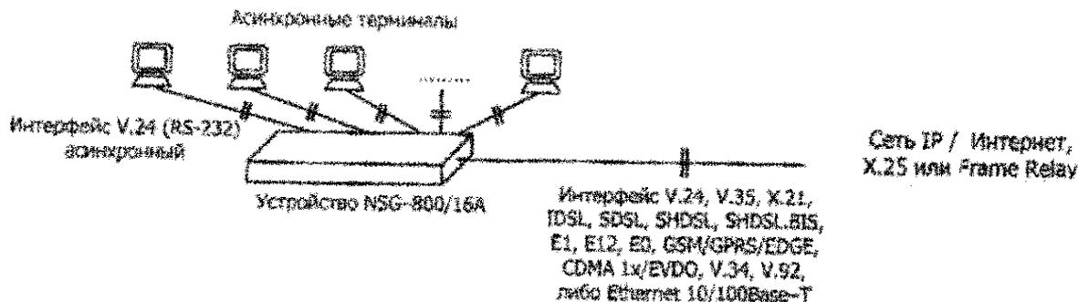
Схема подключения оборудования к сети общего пользования
