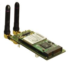
Модуль UM–ET100 представляет собой дополнительный порт Ethernet. Высокоскоростную модификацию UM–ET100 *h/w ver. 3* (полноценный Fast Ethernet) целесообразно использовать на шасси NSG–1800. Аналогичная опция орt1820.Eth предназначена для устройства NSG–1820MC. Более доступная по цене модификация *h/w ver.1* рекомендуется для шасси NSG–700; в отличие от трёх встроенных портов Ethernet на моделях этой серии, включенных через VLAN-коммутатор, это будет полноценный, физически изолированный порт.
