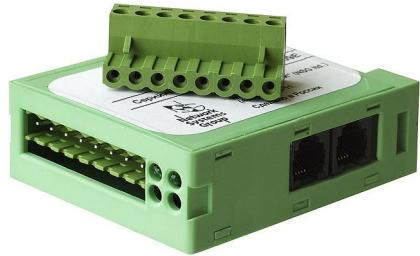
Интерфейсные модули и внешние аксессуары придают маршрутизаторам NSG дополнительную функциональность. Они предназначены для непосредственного мониторинга и управления физическими параметрами, такими как токи (факт замыкания или размыкания электрической цепи), напряжения, температуры и т.п. В частности, с их помощью можно контролировать:
