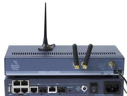
NSG–2030 — высокопроизводительный маршрутизатор доступа, предназначенный для подключения относительно крупных офисов и организаций к Интернет и корпоративным сетям по каналам 100–1000 Мбит/с. В частности, он может эффективно использоваться в таких задачах, как:
