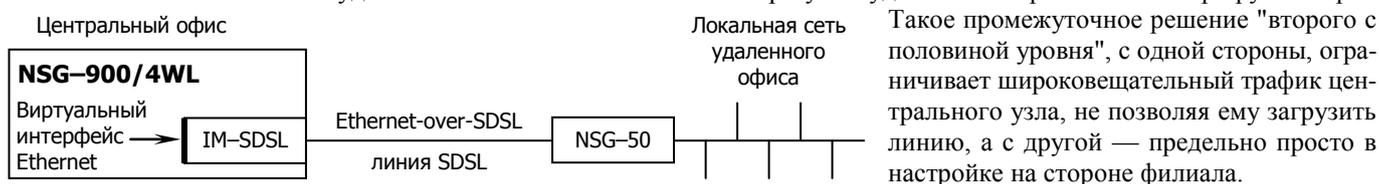
Особое место занимает использование NSG-50 SDSL в сочетании с устройством NSG-700/4AU h/w ver.5. Такое простое и недорогое решение позволяет "подтянуть" к NSG-700 удаленную площадку или, наоборот, соединить NSG-700 в филиале с маршрутизатором в центральном офисе.
