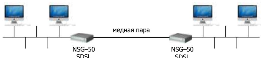
Другой вариант подключения — центральное устройство настраивается как маршрутизатор 3 уровня, а модуль IM-SDSL h/w ver.2 совместно с удаленным мостом NSG-50 SDSL образуют "удаленный порт Ethernet" маршрутизатора<sup>2</sup>.
