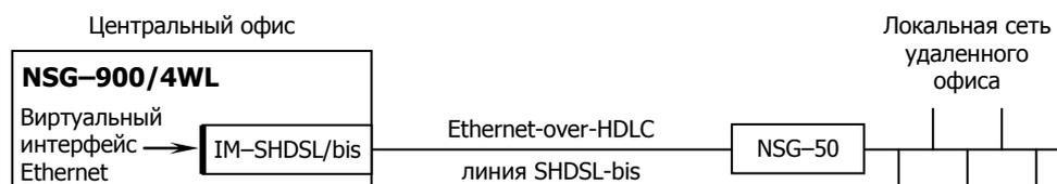
NSG-50 xSHDSL.BIS просты в установке и могут быть включены в сеть без программных настроек. Выбор основных параметров (скорости и режима работы *COE/CPE*) линейных интерфейсов производится с помощью микропереключателей. Остальные параметры при этом устанавливаются по умолчанию, максимальная скорость согласуется автоматически. Для более сложных конфигураций используется настройка через консольный порт.
