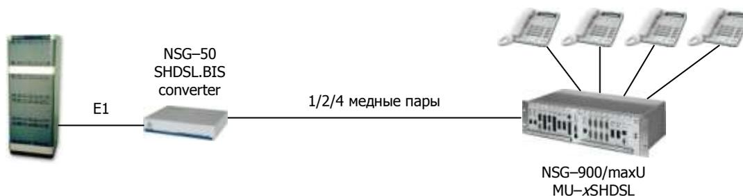
Устройства NSG-50 xSHDSL.BIS modem предназначены для передачи синхронных данных в сетях WAN и оснащены локальным последовательным портом V.35/X.21. Устройства могут работать как с использованием цикловой структуры TDM, так и без него.
