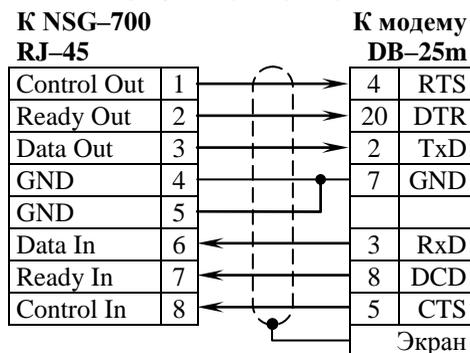
**ВНИМАНИЕ** Назначение контактов асинхронного порта и распайка кабелей для него совпадает с распространенными кабелями компании Cisco Systems и отличается от устройств NSG-500, NX-300, NSG-800, NSG-900.
