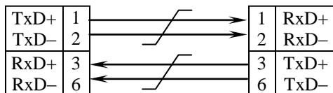
Подключение к портам Fast Ethernet может производиться любым из двух кабелей как для ПК или сервера, так и для коммутатора, концентратора Ethernet.
