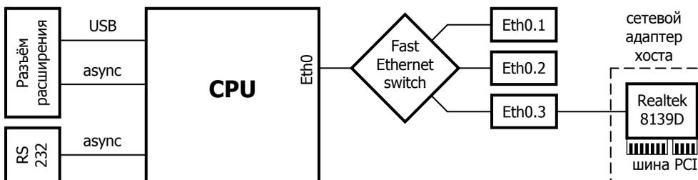
Устройство идентифицируется в хост-компьютере как сетевой адаптер на базе контроллера Realtek 8139D. При необходимости (например, по требованиям безопасности) внутренний порт может быть аппаратно отключен; в этом случае устройство получает от хост-компьютера по шине PCI только электропитание, а обмен данными производится посредством патч-корда через один из внешних портов.
