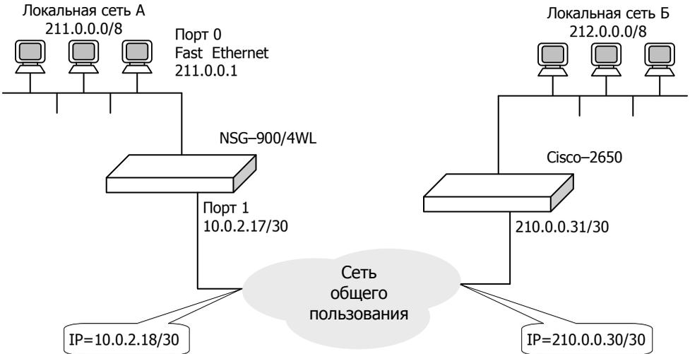
Трафик приватной сети передается между двумя шлюзами в защищенном туннеле с использованием шифрования 3DES и механизма аутентификации Authentication Header (AH) MD5. Назначение ключей осуществляется вручную (статически). Весь остальной трафик, если таковой имеется, принимается и отправляется указанными интерфейсами без какой-либо обработки. (Элементы конфигурации, не относящиеся к данной VPN, опущены.)
