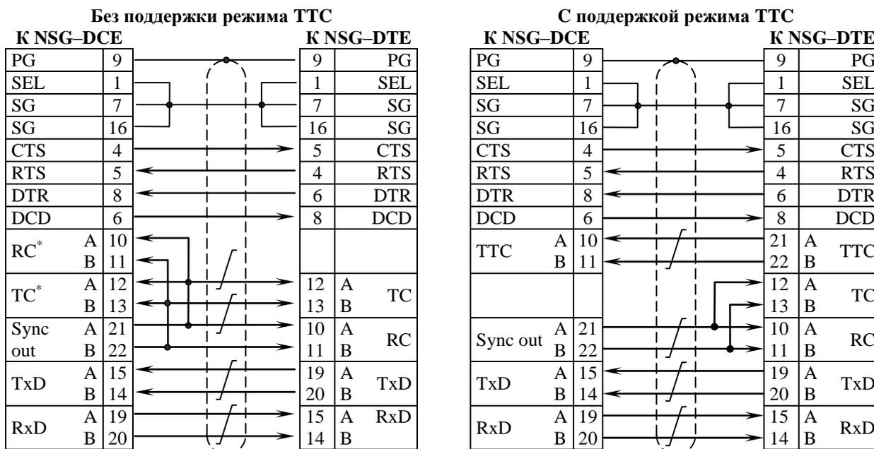
\* Обратный ввод сигналов RC, TC в модуль, работающий в режиме DCE, необходим только для модулей ранних выпусков
