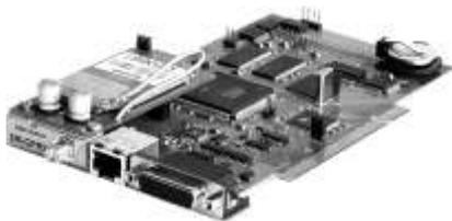
NSG-709 имеет порт Fast Ethernet, полноценный синхронный порт V.24/V.35 (DTE/DCE) и один разъём расширения. Последний поддерживает большинство модулей, предусмотренные для базового шасси, в том числе — все сотовые модемы, модемы ТФОП, Fast Ethernet. С внутренней стороны NSG-709 имеет два асинхронных порта, выходящих на шину PCI и видимых из операционной системы банкомата как очередные COM-порты. Устройство может работать в составе систем под управлением ОС Windows, MS-DOS и Linux.
