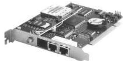
Если соображения безопасности и/или целостности операционной системы запрещают установку в неё дополнительных устройств, то внутренние порты на обеих картах могут быть аппаратно отключены. В этом случае карта полностью изолируется от операционной среды банкомата и получает по шине PCI только питание; обмен данными осуществляется через один из внешних портов.
