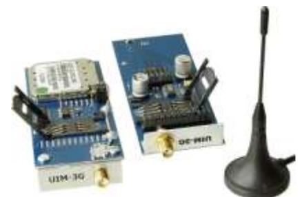
Модули GPRS/EDGE и 3G для маршрутизаторов NSG оснащены двумя SIM-картами
