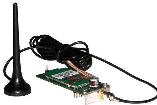
Интерфейсный модуль IM-GPRS
