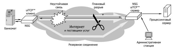
Механизм *ui*TCP способен работать через любые сети и каналы связи, с любыми IP-адресами клиента (статическими или динамическими, глобальными или приватными). Он универсально применим ко всем типам сетей, со всеми типами среды передачи и скоростями, которые поддерживаются маршрутизаторами NSG: ЛС Ethernet сторонних организаций, городские сети Fiber Ethernet, сотовые сети всех существующих стандартов (GSM, CDMA, 3G), коммутируемые модемные линии, *x*DSL, E1 и др.
