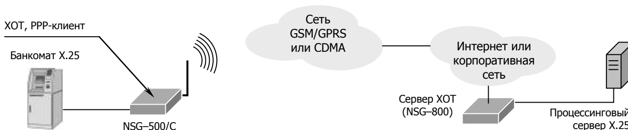
Рис. 14. Подключение банкомата X.25 через беспроводную сеть в пакетном режиме
